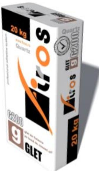
Glet pe bază de ciment alb pentru nivelarea fină și finisarea suprafețelor interioare tencuite cu tencuieli pe bază de ciment sau ciment/var. Nu se aplică peste var sau humă, pe suporturi din ipsos, lemn, metal sau plastic.
